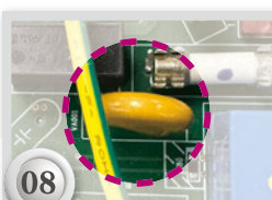
突波保護器防止高電壓進入機體，造成機體損壞
