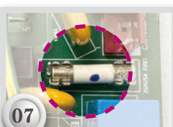
電流保險絲阻斷過大電流，避免機體受損
