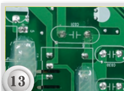
IC高壓接腳防潮絕緣處理
