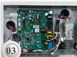
電源基板採難燃材質包覆設計
